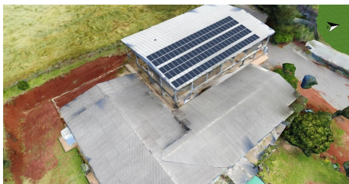
Figura 2 – Distribuição dos módulos no telhado. (259 m 2 )
