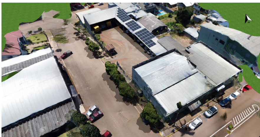
Figura 2 – Distribuição dos módulos no telhado. (138,1 m 2 )
