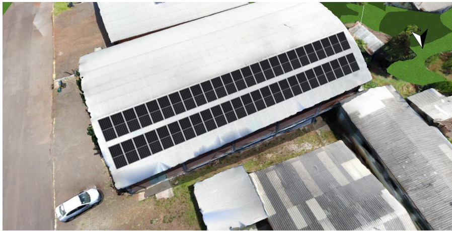
Figura 2 – Distribuição dos módulos no telhado. (155,4 m 2 )
